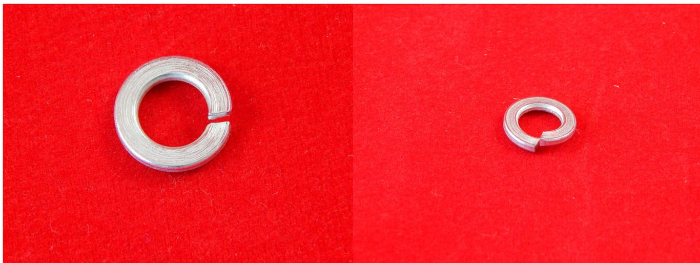
Пружинная шайба (шайба Гровера, гровер) — разрезная круглая шайба, концы которой расположены в разных плоскостях. Служит для предотвращения самоотвинчивания резьбовых соединений за счет упругой деформации шайбы под нагрузкой.
