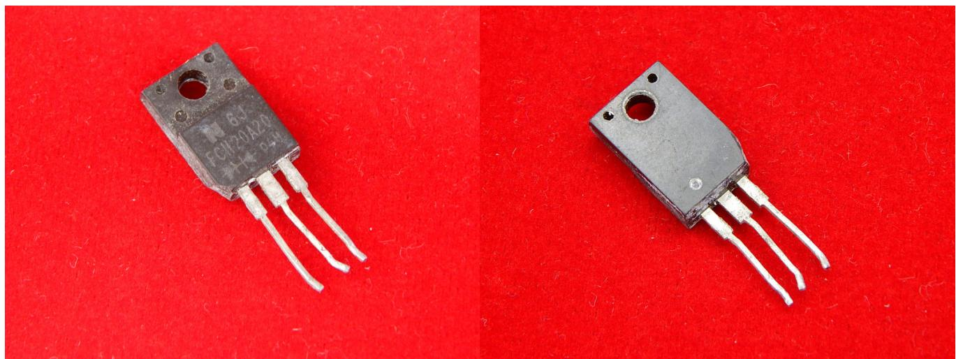
Диод для высокочастотного выпрямления. 2 диода, 200V, 20A, TO220F
