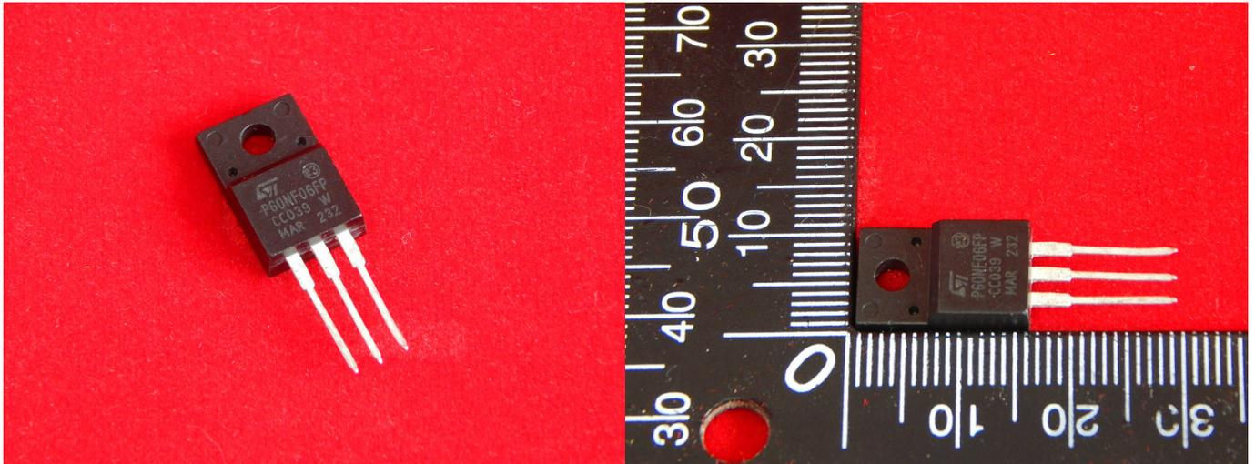
STP60NF06FP Транзистор MOSFET, N-канал, 60V, 30A TO220FP
