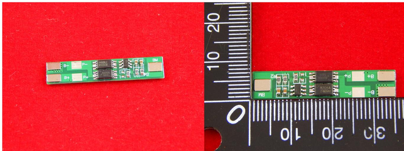
Контроллер заряда, разряда, защиты, для сборки из двух последовательно соединенных литиевых аккумуляторов 2S Li-Ion 7.4V...8.4V. Позволяет осуществлять заряд двух последовательно соединенных элементов, а также контролирует их разряд во время нагрузки.
