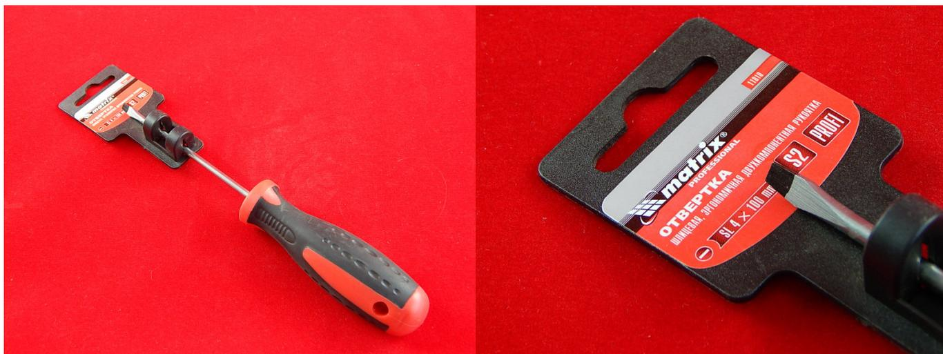
Жало отвертки изготовлено из легированной инструментальной стали S2 и закалено. Наконечник жала намагничен. Твердость рабочей поверхности 58-62 HRC. Двухкомпонентные рукоятки эргономичной формы изготовлены методом цельного литья для увеличения прочности сцепления ручки с рабочей частью.
