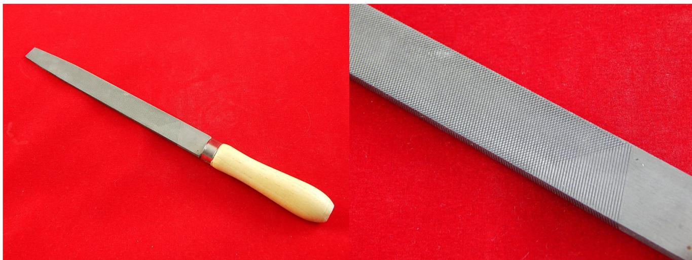
Напильник предназначен для качественной обработки плоских поверхностей твердых материалов. Инструмент имеет двойную перекрестную насечку №2. Ширина плоской части напильника уменьшается от середины к носу. Напильник изготовлен из углеродистой стали. Поставляется в комплекте с деревянной рукояткой, покрытой бесцветным лаком, который защищает древесину от рассыхания и набухания.
