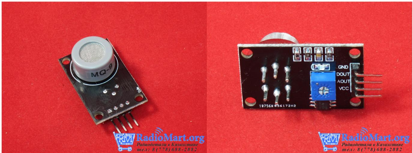
Датчик газа, построенный на базе газоанализатора MQ-9 позволяет обнаруживать наличие в окружающем воздухе углеводородных газов (пропан, метан, н-бутан) и угарного газа (CO).
