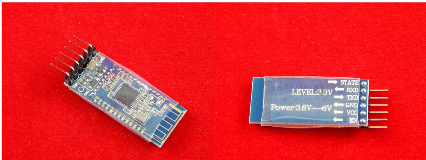
Это новый компактный Bluetooth модуль четвертого поколения, обладающий ультранизким энергопотреблением в режиме ожидания. Технология Bluetooth Low Energy (BLE) - Bluetooth 4.0 является технологией беспроводной связи для ближних коммуникаций.
