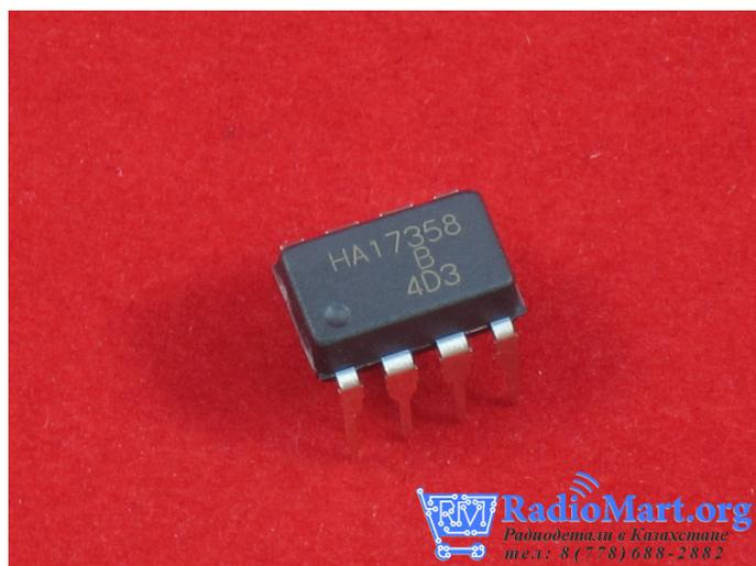
Усилитель постоянного тока с дифференциальным входом и, как правило, единственным выходом, имеющий высокий коэффициент усиления. ОУ почти всегда используются в схемах с глубокой отрицательной обратной связью, которая, благодаря высокому коэффициенту усиления ОУ, полностью определяет коэффициент передачи полученной схемы.
