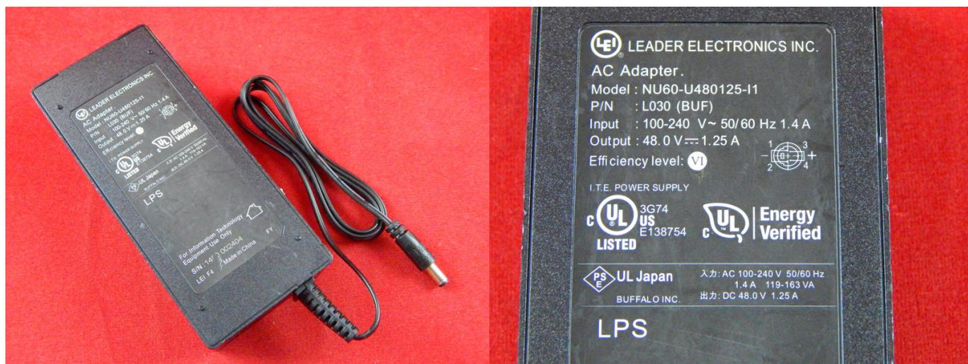
Блок питания для POE с напряжением 48В при токе до 1.25А.
