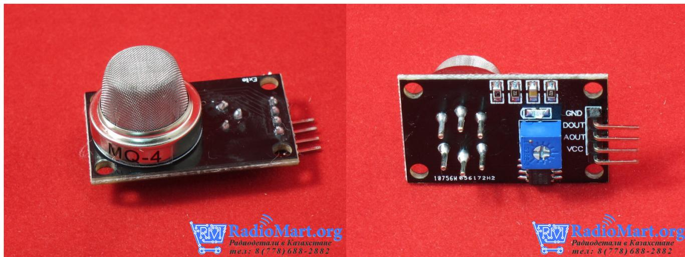
MQ-4 - предназначен для выявления  $\text{CH}_4$  (то есть метана), природного газа (большую часть которого также составляет метан), пары алкоголя, сигаретного и кухонного дыма.
