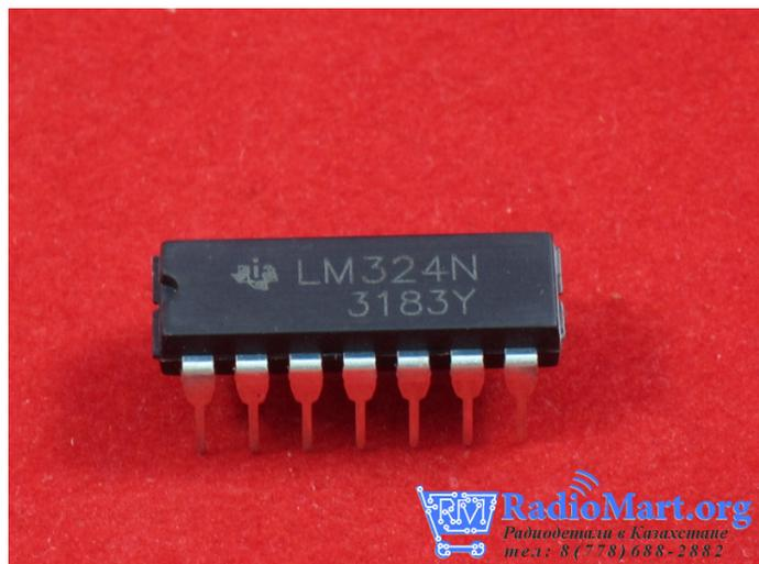
Микросхема LM324N - 4-канальный операционный усилитель широкого применения для работы в бытовом диапазоне температур.
