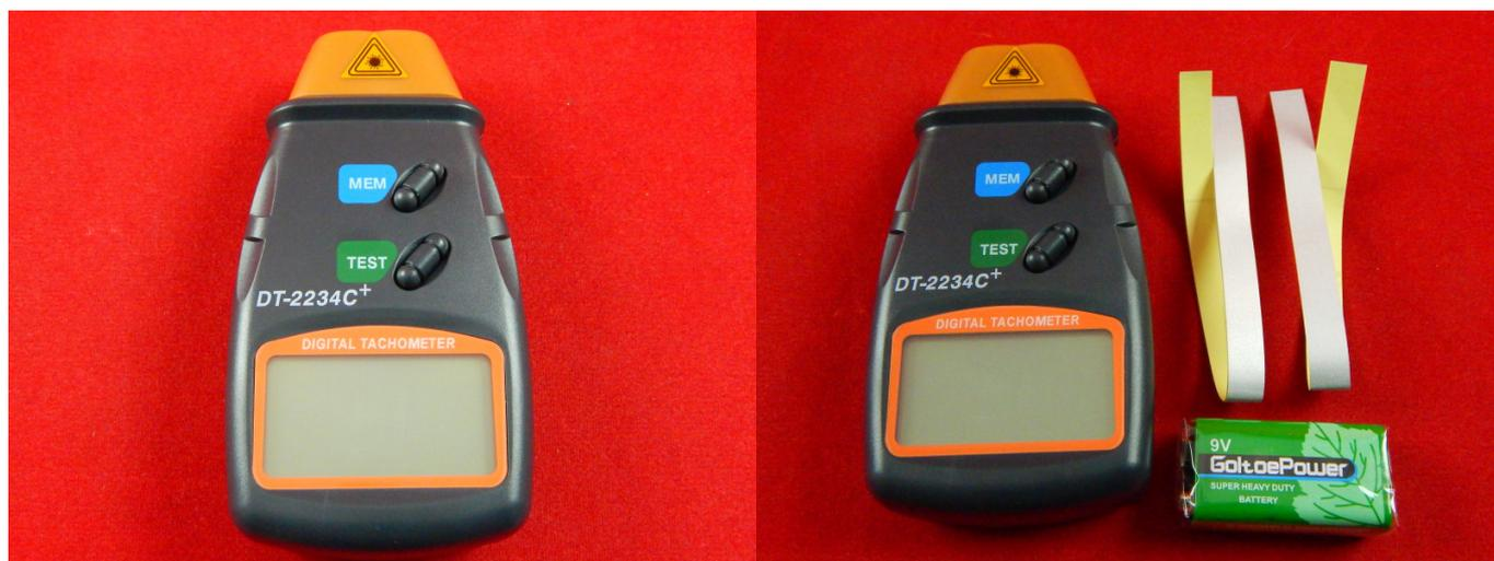
DT2234 цифровой тахометр предназначен для выполнения измерения скорости вращения деталей машин и механизмов. В основу измерения скорости вращения положен принцип подсчета количества импульсов от вращающейся метки за единицу времени. В комплект поставки включены светоотражающие полосы.
