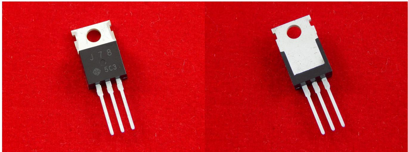
2SJ78, Полевой транзистор, Р-канальный, 180 В, 0.5 А, 30 Вт (комплементарная пара 2SK215)
