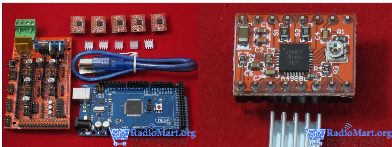
Электроника для 3D принтеров RepRap, MendelPrusa. Предназначен для собственной сборки 3D принтера.
