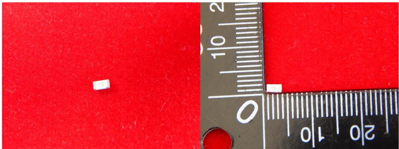
Предохранитель керамический плавкий.
