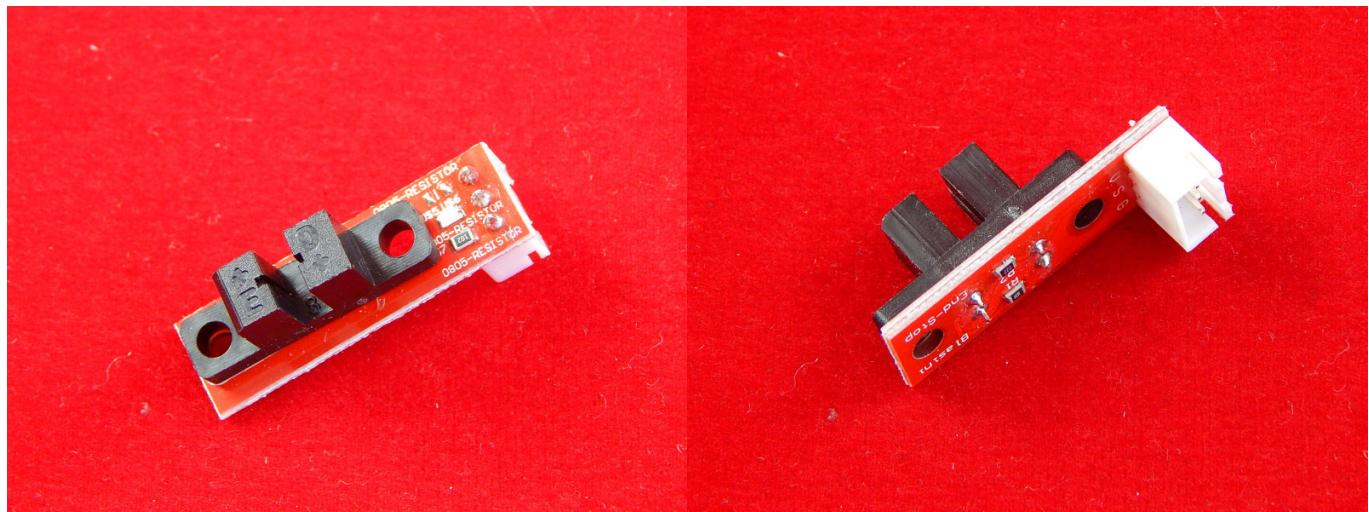
Оптический концевик для точного позиционирования на ЧПУ
