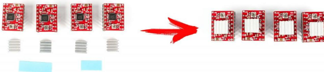
Драйвер устанавливается строго в одном положении — подстроечным резистором в противоположную сторону от разъема питания (маркировка ножек драйвера должна совпасть с маркировкой на плате). Радиаторы не должны касаться ножек подстроечного резистора!
