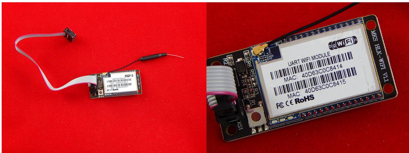
Модуль беспроводной связи от Makerbase (МКС) на основе чипа HLK-RM04 позволяет использовать сеть Wi-Fi для доступа к 3D-принтеру. Настройка осуществляется через прошивку контроллера или беспроводную сеть, для входа используются логин/пароль по умолчанию admin/admin.
