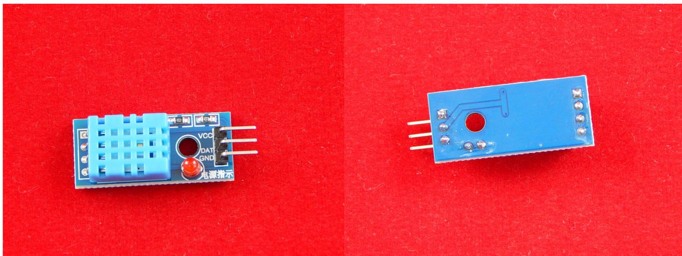
Датчик DHT11 состоит из емкостного датчика влажности и термистора. Также, датчик содержит в себе простенький АЦП для преобразования аналоговых значений влажности и температуры.
