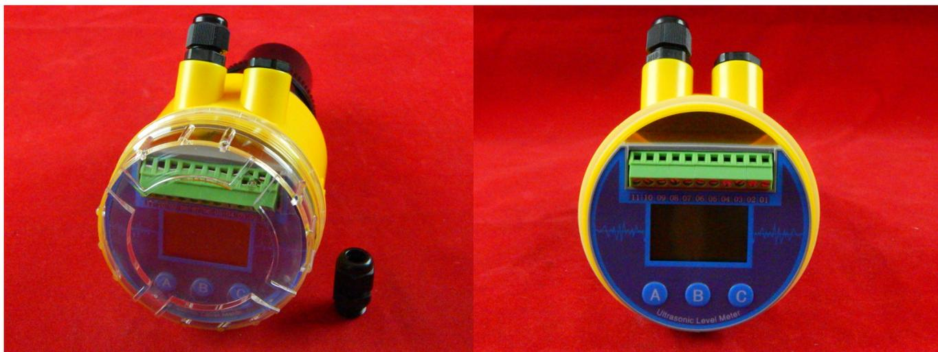
Ультразвуковой измерительный прибор для контроля уровня жидкости в резервуаре.
