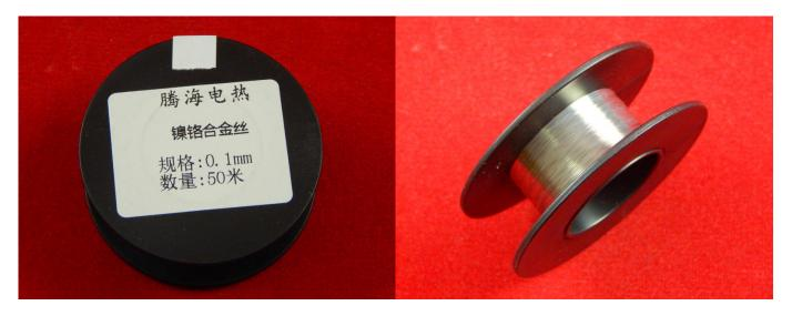
Нихром - основной материал для изготовления нагревательных элементов для электрических печей. Нихром специально разработан для этой цели и поэтому в максимальной степени удовлетворяет всем требованиям к таким материалам.
