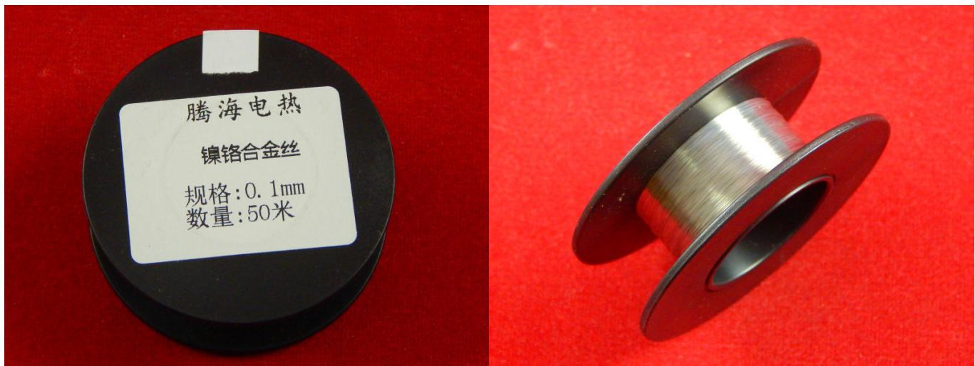
Нихром - основной материал для изготовления нагревательных элементов для электрических печей. Нихром специально разработан для этой цели и поэтому в максимальной степени удовлетворяет всем требованиям к таким материалам.
