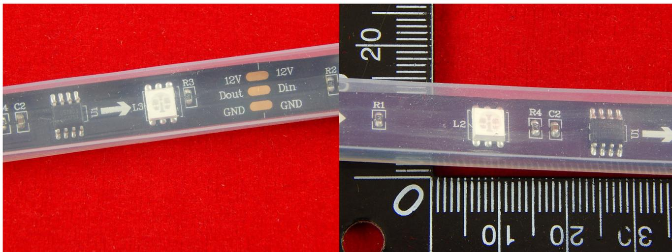
LED-модуль из 150 RGB светодиодов в прозрачной гелевой оболочке со встроенным контроллером WS2811 на каждые 3 светодиода. Применяется для создания видеобукв, в качестве интеллектуальной полноцветной контурной подсветки, сплошного заполнения рекламных элементов, для создания экранов и многих других целей.
