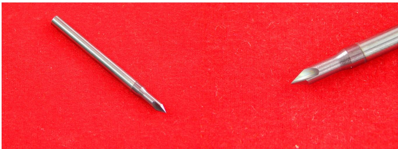
Тверда сплавная фреза для гравировки на различных материалах, снятия фасок. Размер 3,0\*50\*60°
