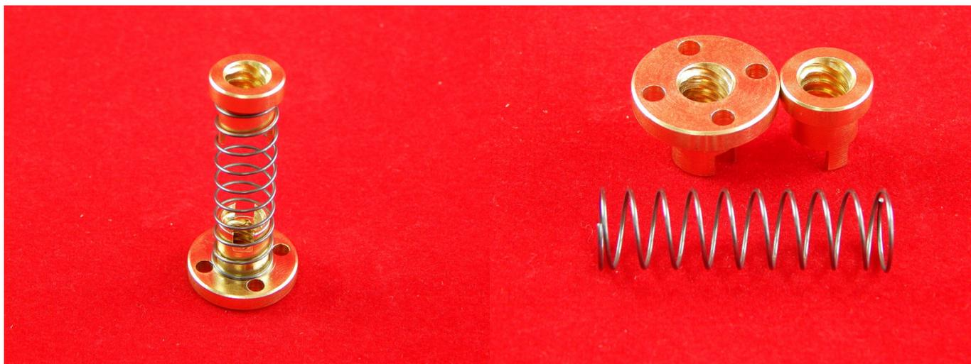
Бронзовая безлюфтовая гайка для трапецидального винта 8 мм. Используется для уменьшения погрешности перемещений в механизме вращательно-поступательного движения.
