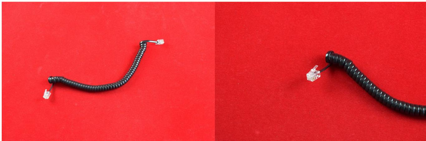
Данный вид кабеля используется в проводных телефонных ip-телефонах для соединения телефонной трубки и аппарата.
