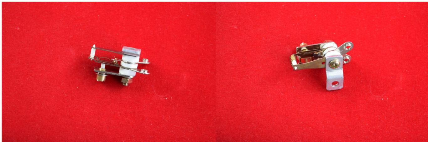
KSD101 - это термостат на основе биметаллической пластины. Содержит одну группу контактов на размыкание. Используется в электро-плитах, скороварках, рисоварках, и тд
