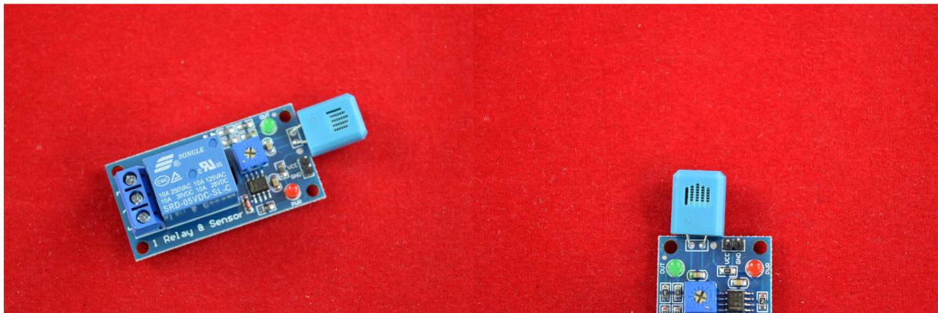
Релейный модуль с датчиком влажности.
