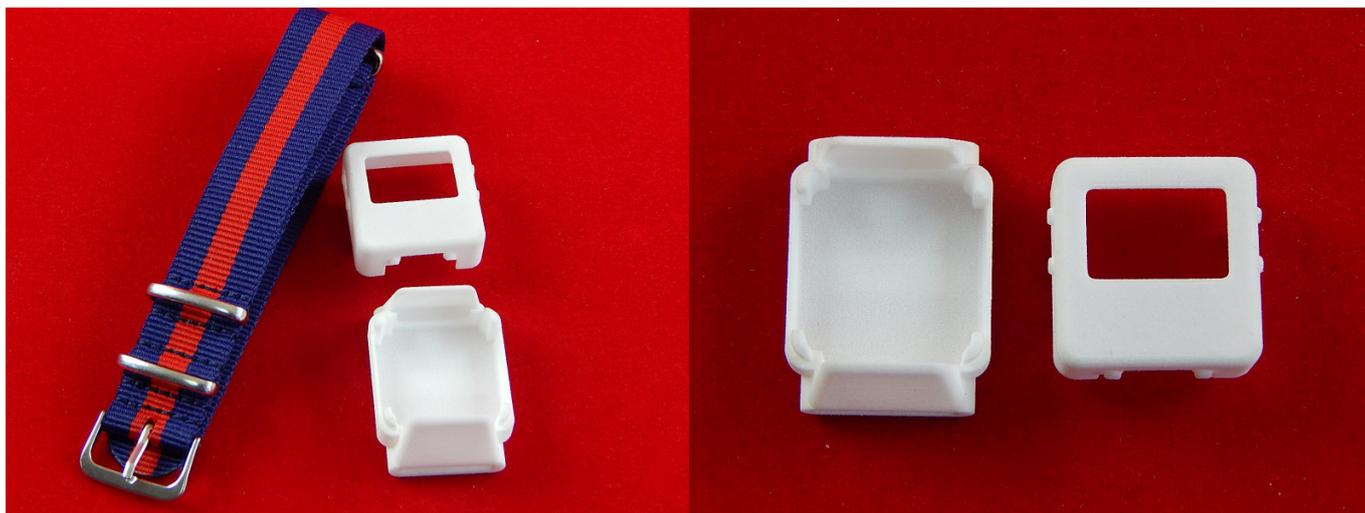
Корпус и ремешок для сборки умных часов на основе TinyScreen и TinyDuino.
