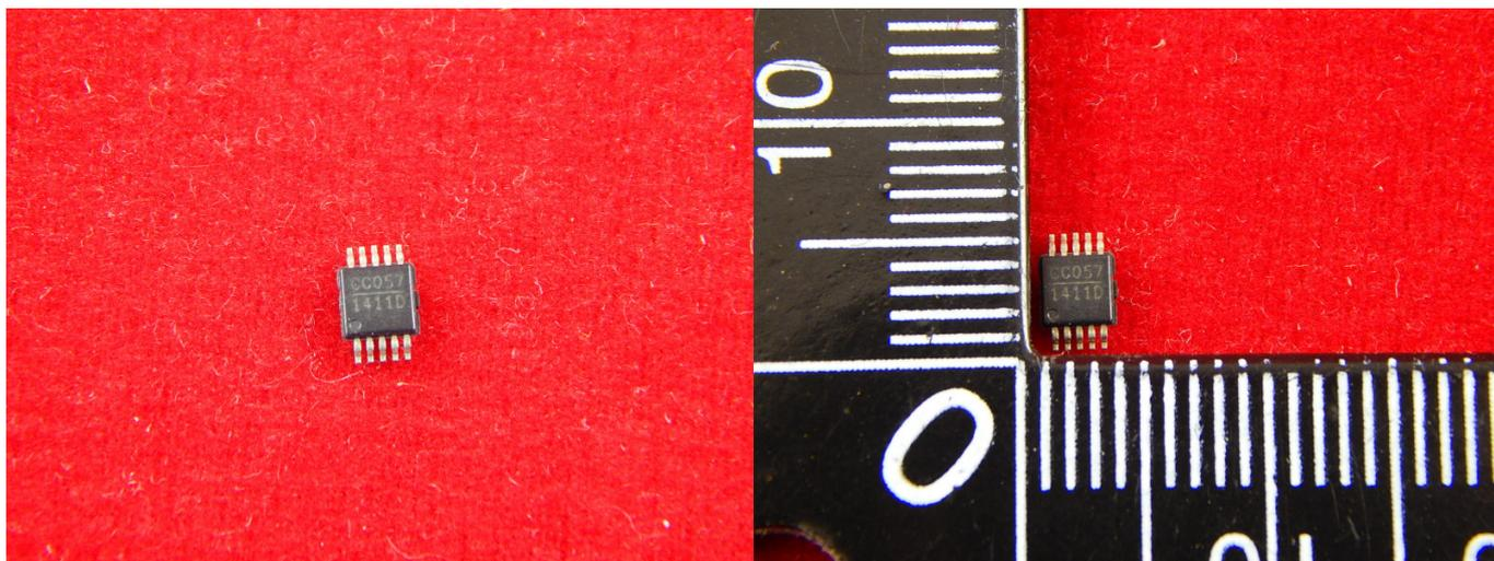
DC/DC преобразователь напряжения (Step-Down) 0.92-16V/2A, 380кГц
