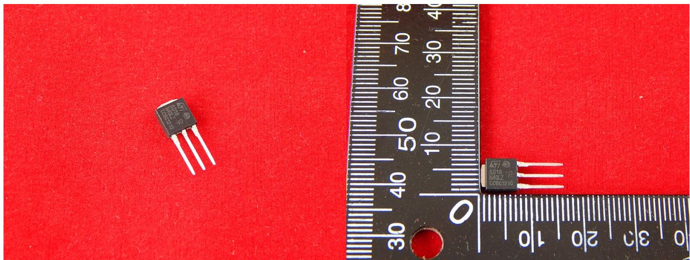
STGD18N40LZ биполярный транзистор с изолированным затвором. Транзистор имеет защиту на канале затвор-эмиттер.
