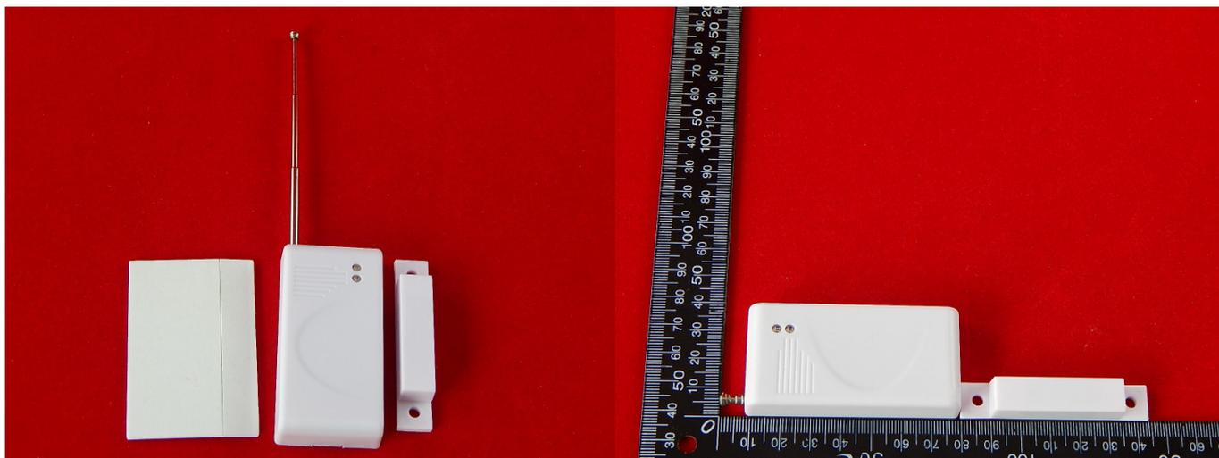
Магнитоcontactный беспроводной датчик используется для контроля проникновения в помещение через двери или окна. Это один из наиболее часто применяемых датчиков для защиты домашних и офисных помещений. Данный датчик входит в комплект, который можно купить "[здесь](#)".
