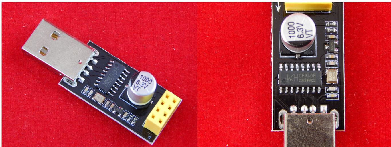
Удобный USB конвертер для программирования ESP8266 ESP-01 WIFI модулей.
