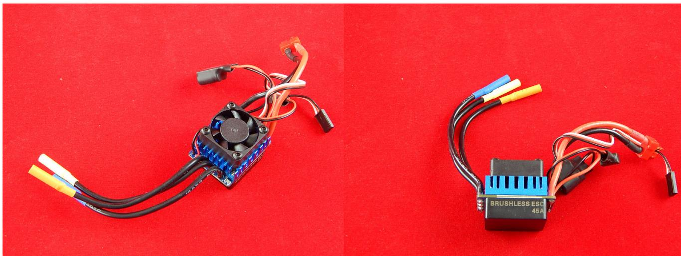
45 амперный ESC регулятор для автомоделей с бесколлекторными электродвигателями.
