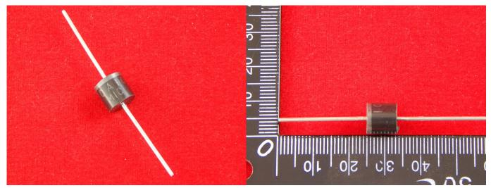
**Uобр.** тах (постоянное) 1000V Uобр.max (импульсное, повтор.) 1000V **Uобр.** тах (действующее) 700VAC Іпрям.max (при t=+50°C) 10A\* Іпрям.имп.max (8,3mS) 400A **Uпрям.** (не более) 1V Iобр. (при t=+25°C, не более) 10µA С (ёмкость перехода) 120pF -60..+150°C Диапазон температур 2,1g Bec R-6 Тип корпуса
