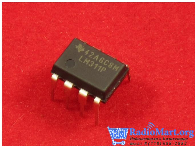
LM311P – интегральный компаратор напряжения, характеризующийся очень малым входным током.
