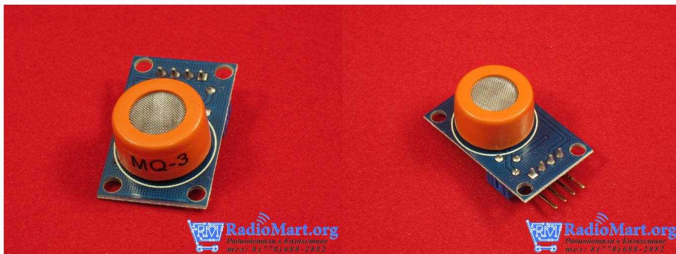
Датчик газа, построенный на базе газоанализатора MQ-3 позволяет обнаруживать наличие паров спирта: от парфюмерии или спиртных напитков, в воздухе или дыхании.
