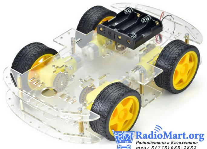
Комплект для сборки движущейся 4-х колесной платформы с двигателями. Имеет простую структуру, с уровнем шума <65dB, хорошо подойдет для измерений скоростей и расстояний.
