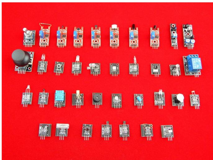
Набор различных датчиков для конструирования и проектирования совместно с набором микроконтроллером Arduino
