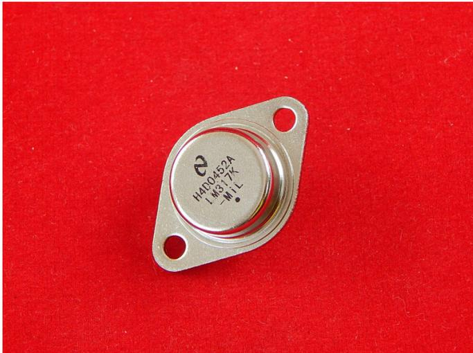
Стабилизатор напряжения регулируемый 1,2-37V 1,5A
