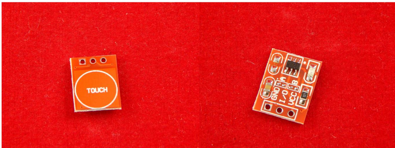
Миниатюрный датчик касания на микросхеме TTP223.
