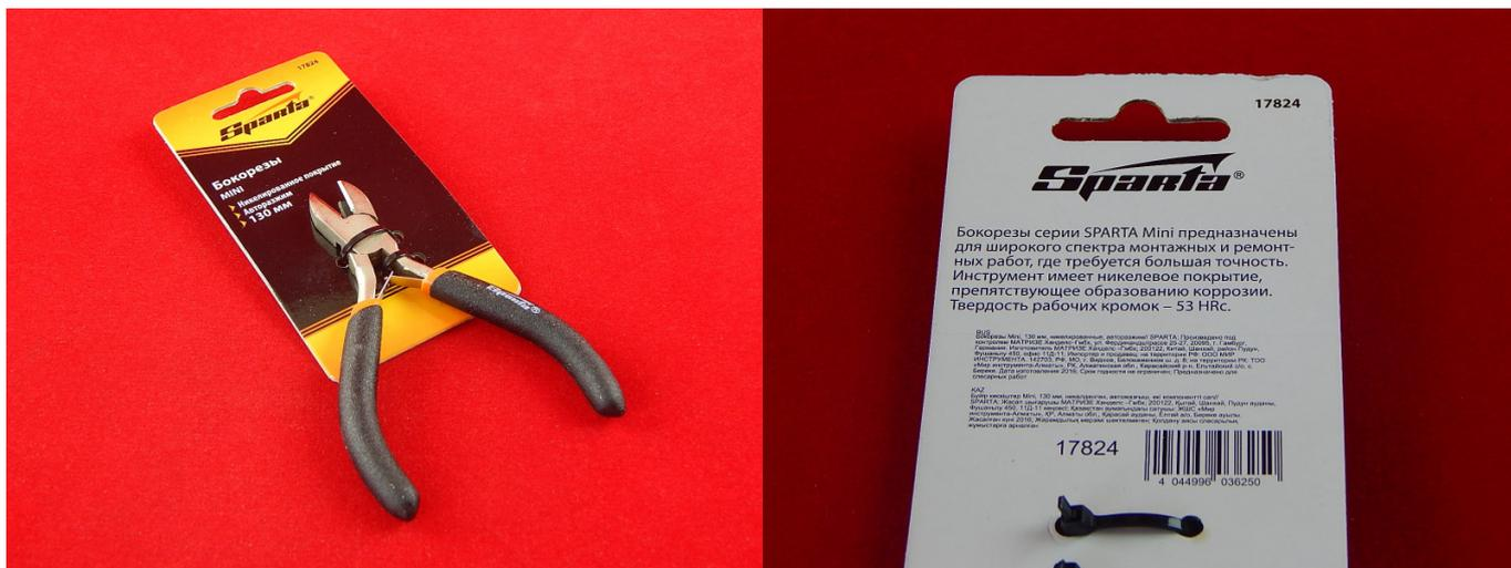
Шарнирно-губцевый инструмент серии MINI предназначен для широкого спектра слесарных и монтажных работ, в которых требуется особая точность. Инструмент изготовлен из инструментальной углеродистой стали марки У7 и имеет никелированную поверхность. Твердость режущих кромок 53 HRC. Твердость зажимных частей 45,5 HRC.
