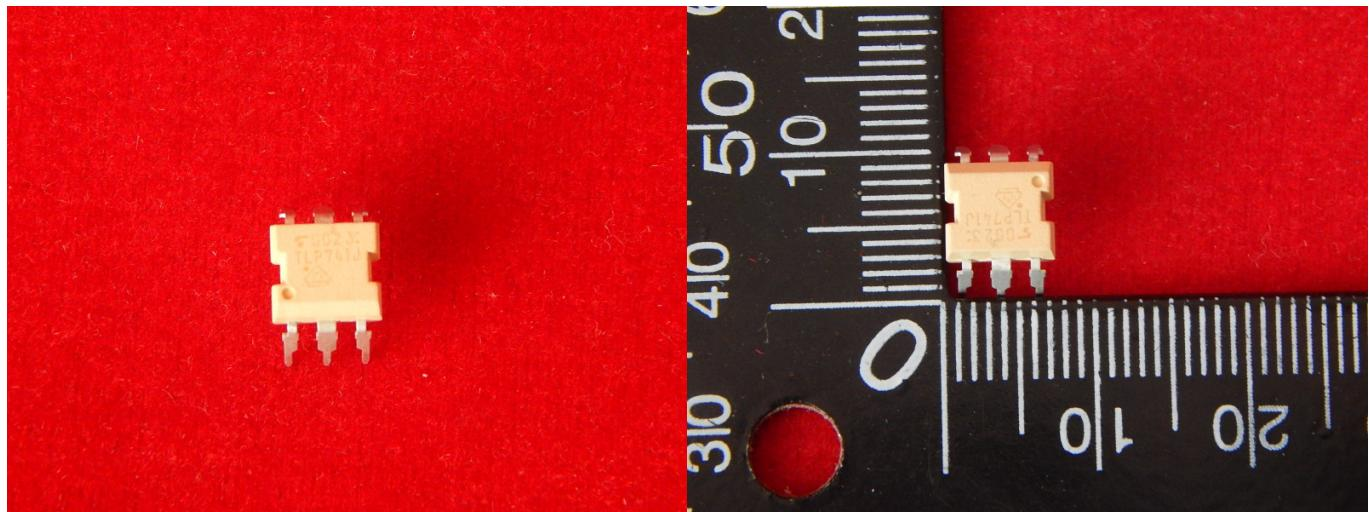
**TLP741J, Оптопара с симисторным выходом 4.0kV 600V 3.0A 150mA 0.25W**
