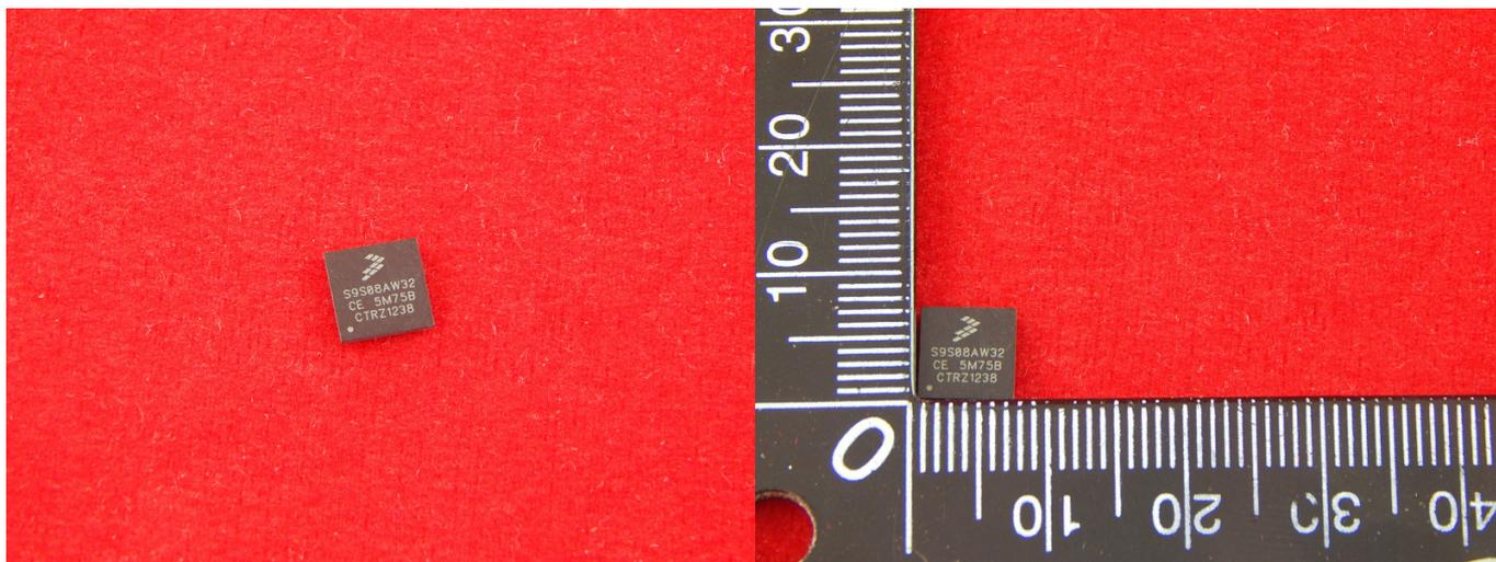
MC9S08AW32 компактный, не дорогой, высокопроизводительный микроконтроллер семейства 8-разрядных микроконтроллеров основанных на ядре HCS08.
