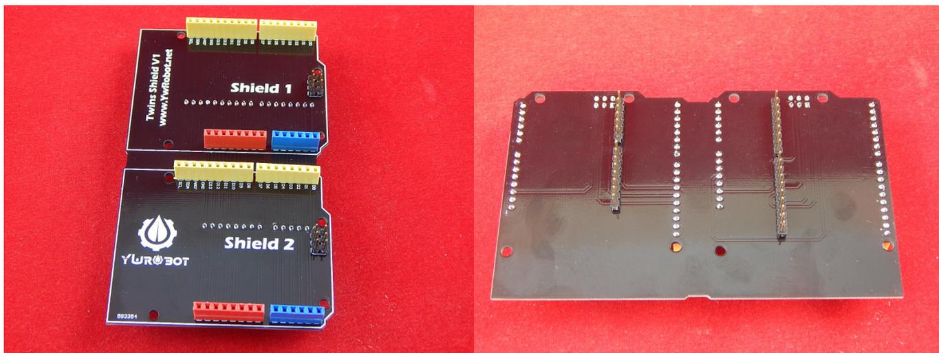
Double Shield (Сдвоенный шилд) — это плата расширения, которая упрощает процесс подключения Shield'ов к Arduino. Использование Double Shield упрощает процесс создания устройств, а так же позволяет использовать его как тройник для Shield'ов, которые невозможно установить друг на друга или которые перекрывают доступ к выводам для другого Shield'а.
