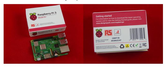
Мегагерц много не бывает — процессор Raspberry Pi 3 B+ разогнан до 1,4 ГГц. Ускорились сетевый и беспроводные интерфейсы, а ещё появилась поддержка Power over Ethernet.
