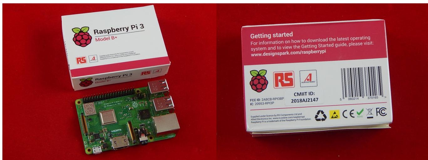
Мегагерц много не бывает — процессор Raspberry Pi 3 B+ разогнан до 1,4 ГГц. Ускорились сетевой и беспроводные интерфейсы, а ещё появилась поддержка Power over Ethernet.
