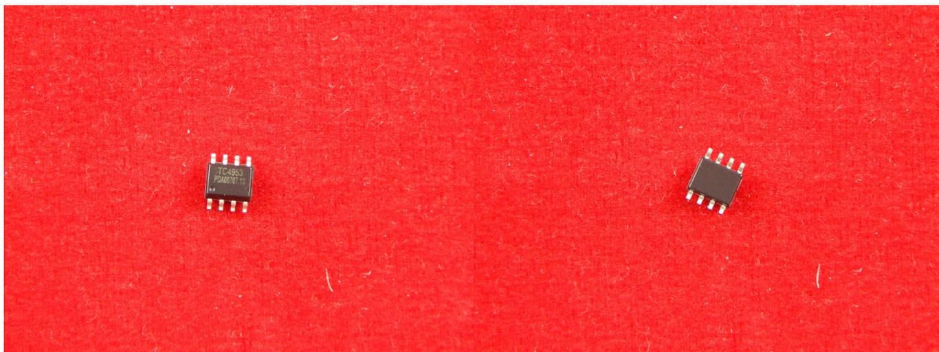
TC4953 - Два транзистора с P каналом в корпусе SO-8
