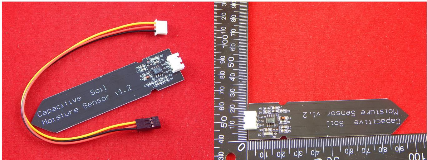
Емкостной аналоговый датчик влажности почвы. В отличие от распространённых датчиков проводимости почвы, не имеет электрического контакта с почвой и, соответственно, не подвержен коррозии. Высокая рабочая частота позволяет снизить зависимость показаний от солевого состава почвы.
