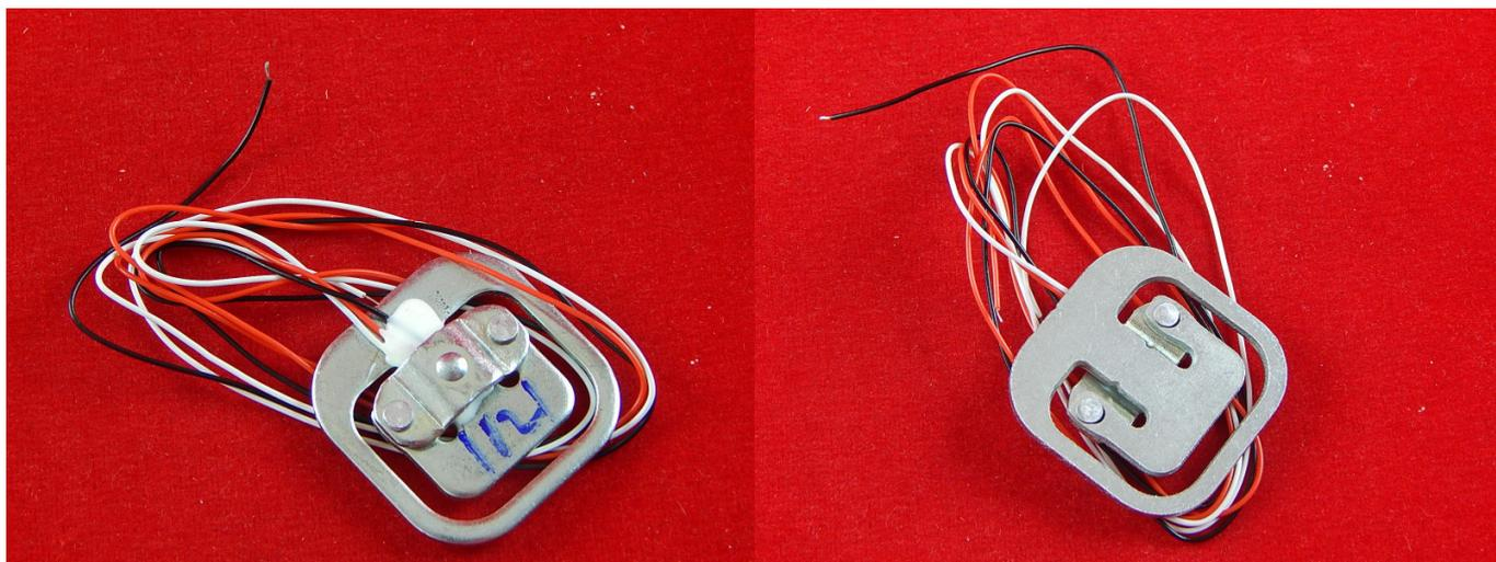
Тензодатчик полумостовой, с пределом измерения 50 кг. При использовании 4-х датчиков по углам весов можно получить измерение до 200 кг.
