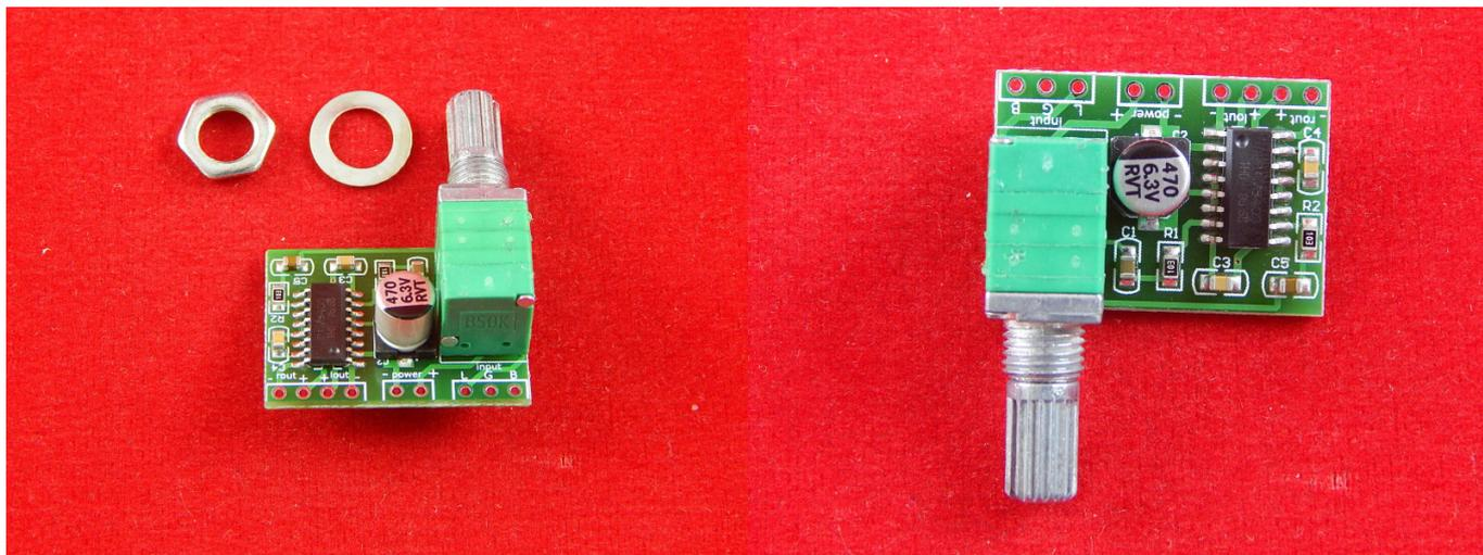
Плата 2-х канального стерео усилителя мощностью 3W с регулятором громкости на РМ8403
